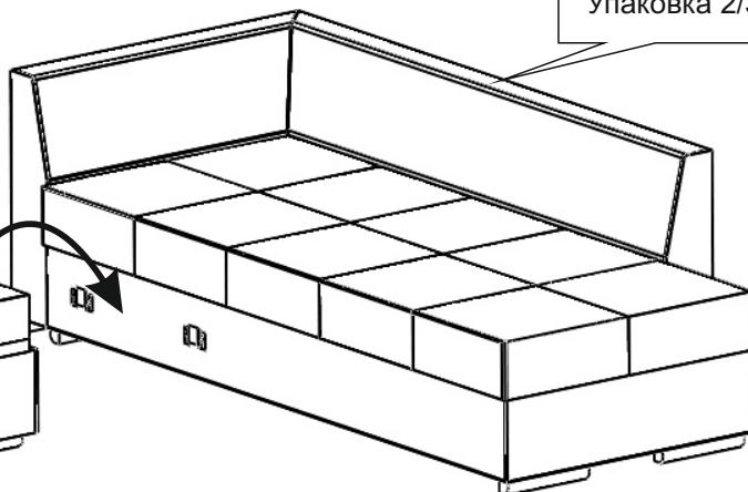
3. Шухляду, (упаковка 3/3), вставляємо у зазначену нишу в оборотній частині кута відчепивши гачок-фіксатор та повернувши сидіння.
