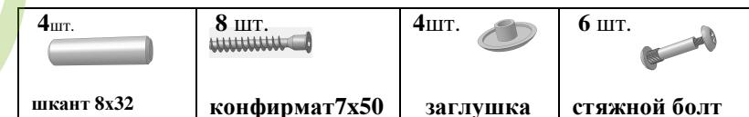
Выбрать из пачек нужные элементы (размеры элементов указаны в таблице). В отверстия Ø8мм., которые находятся в торцах элементов залить клей, затем вбить шканты. Сложить пиллястру согласно рисунку (учитывая нумерацию в таблице) и скрепить конфирматами 7x50, используя при этом специальный **ключ**. Стяжной болт используется для крепления пиллястры к боковой тумбе. После сборки самостоятельно засверлить отверстия сверлом Ø8мм. и скрепить тумбы.
