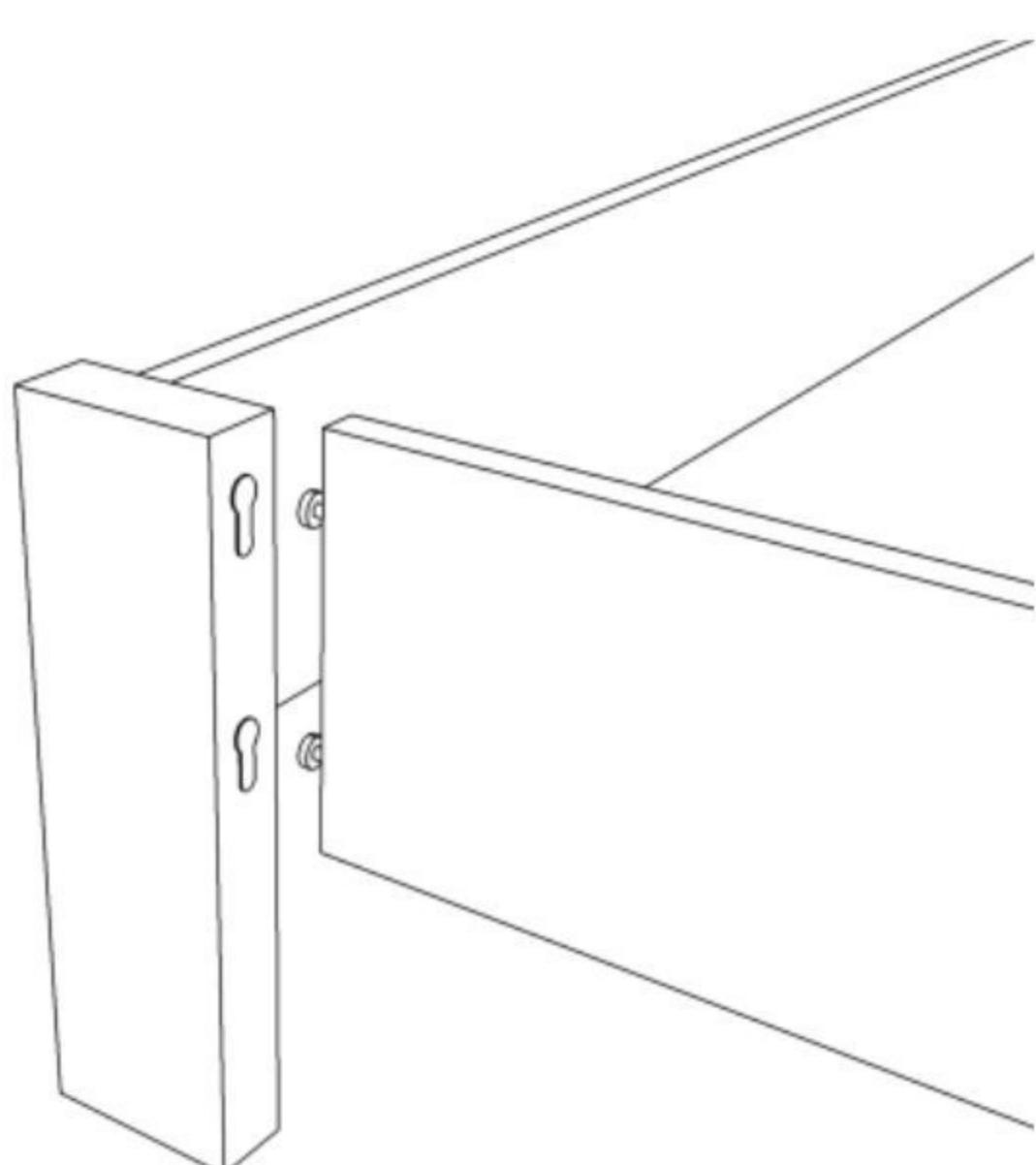
Для складання деталей використовується клиноподібне з'єднання. Потрібно вставити одну деталь в іншу, та з силою натиснути на торець вниз до упору і деталі зібрані. Якщо Вам здається, що деталі стяглися між собою недостатньо щільно, потрібно підтягнути гвинти хрестоподібної викруткою на потрібну відстань, та повторити спробу.
