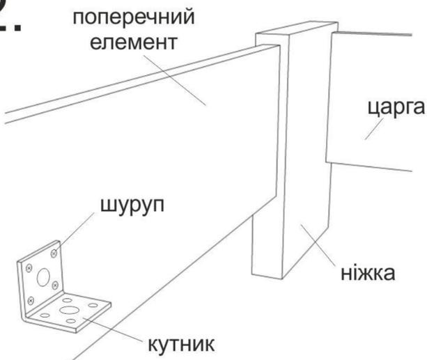
Знайдіть на поперечних елементах попередньо підготовані отвори і використовуючи хрестоподібну викрутку та шурупи, прикріпіть до неї металевий кутник, як показано на малюнку.
