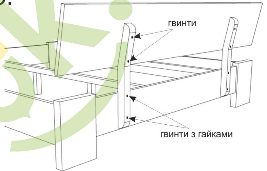
Для кріплення спинки до поперечного елемента використовуються стійки які кріпляться до нього гвинтами з гайками та гвинтами до спинки.
