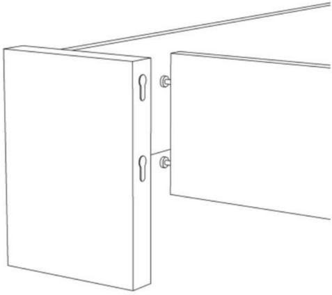
Для складання деталей використовується клиноподібне з'єднання. Потрібно вставити одну деталь в іншу, та з силою натиснути на торець вниз до упору і деталі зібрані. Якщо Вам здається, що деталі стяглися між собою недостатньо щільно, потрібно підтягнути гвинти хрестоподібної викруткою на потрібну відстань, та повторити спробу.
