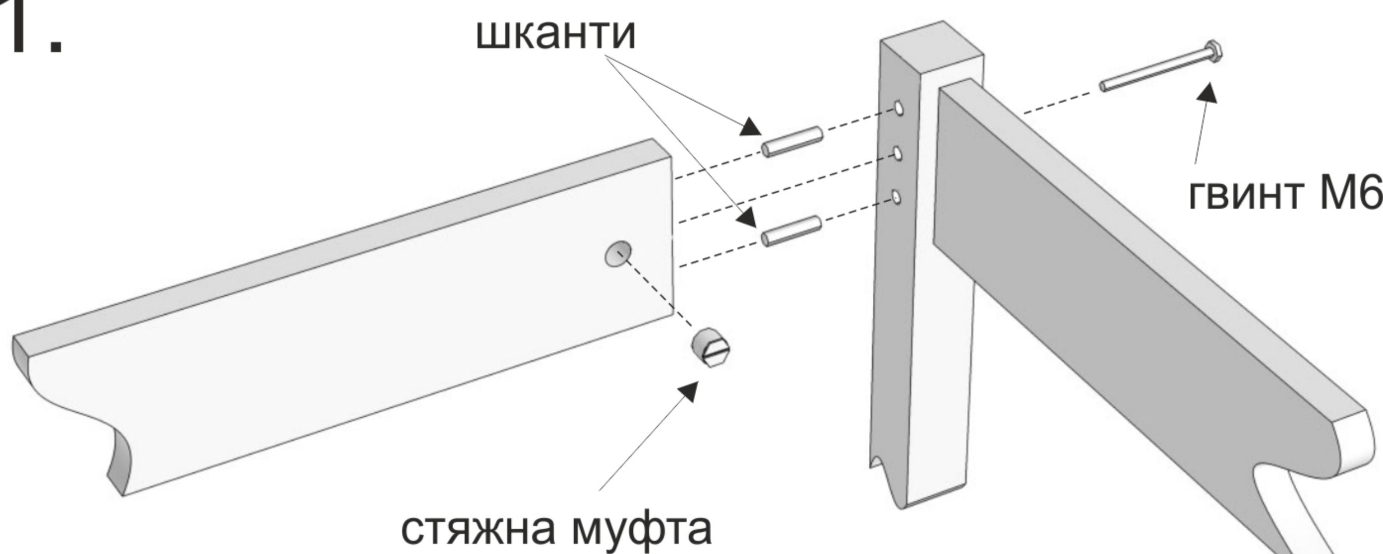
Для складання елементів використовуються стяжні та шкантові з'єднання.
