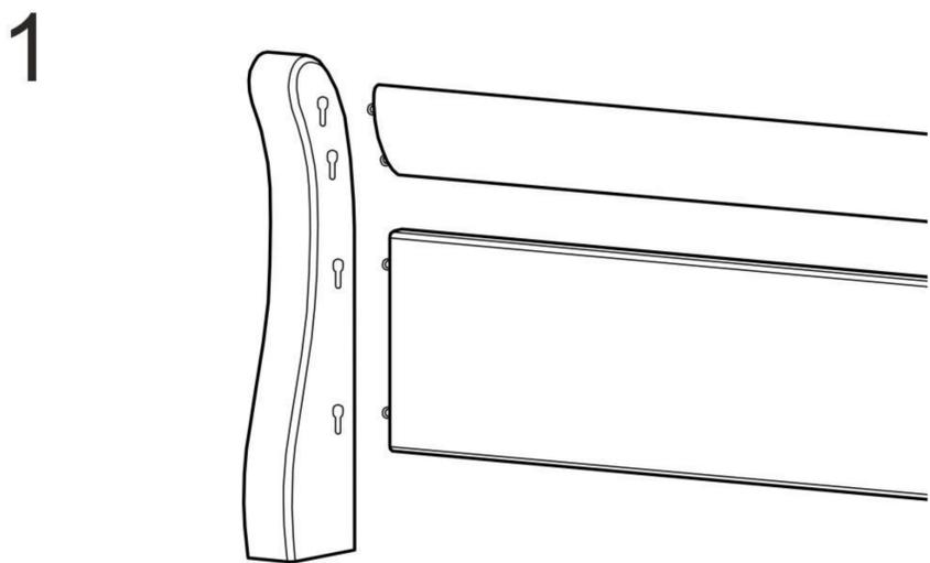
1. Для складання деталей використовується клиноподібне з'єднання. Потрібно вставити одну деталь в іншу, та з силою натиснути на торець вниз до упору і деталі зібрані. Якщо Вам здається, що деталі стяглися між собою недостатньо щільно, потрібно підтягнути гвинти хрестоподібної викруткою на потрібну відстань, та повторити спробу.
