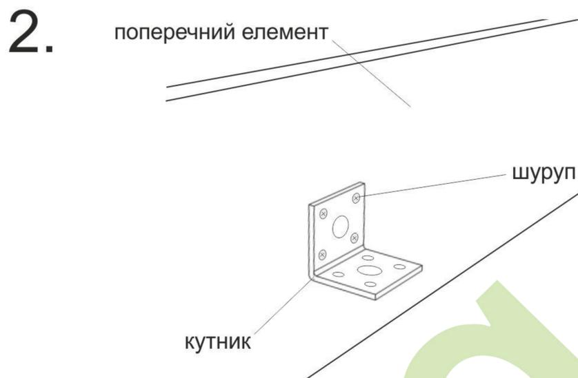
2. Знайдіть на поперечних елементах попередньо підготовані отвори і використовуючи хрестоподібну викрутку та шурупи, прикріпіть до неї металевий кутник, як показано на малюнку.
