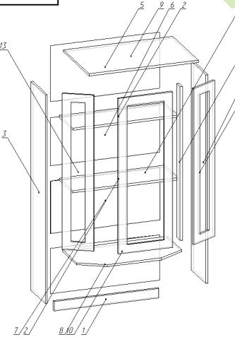
\* Устанавливаем боковые рамочные фасады на колышки, предварительно смазав клеем ПВА. Прижимаем максимально к верхней крышке убедившись, что зазор между верхней крышкой и рамочным фасадом минимальный ( $1,0 \pm 1,5$  мм) фиксируем внизу при помощи угольников соединителя профилей(№13) и шурупов (3x16 мм) в двух точках.
